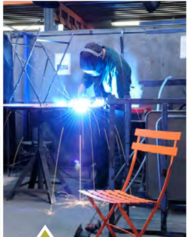
Chaque année, environ 400.000 pièces sortent de l'usine Fermob de Thoissey (Ain). Des contrôles rigoureux interviennent tout au long du processus de fabrication : sur les matières premières d'abord, puis pour tester les soudures, la peinture, le montage, l'assemblage...et enfin le produit fini. Chaque produit est signé par la personne qui l'a contrôlé, c'est à la fois une responsabilité...et une fierté !
